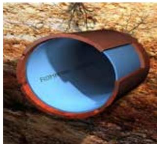
*Sanierung Abwasserleitung mittels Inliner*
